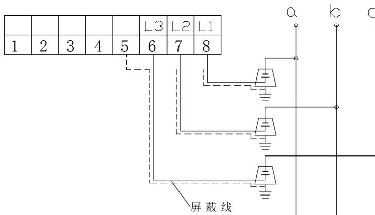
接线图2 T型显示器
